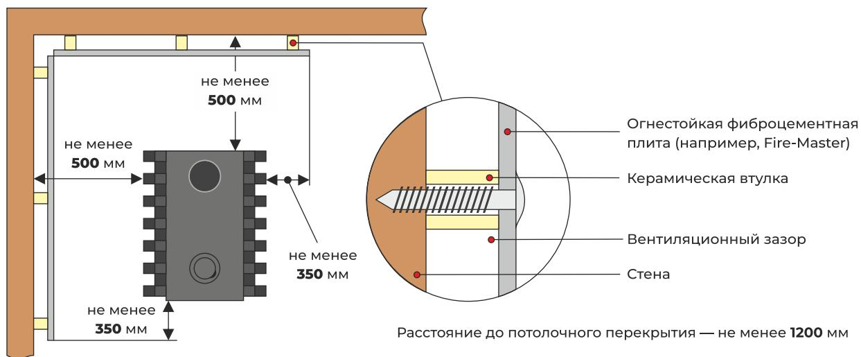
Безопасные расстояния с боков и за печью могут быть уменьшены на 50%, используя огнезащитные материалы (базальтовый лист, фиброцементная плита, кирпичная кладка) с воздушным зазором не менее 30 мм до изолируемой сгораемой поверхности (для обеспечения вентиляции).
